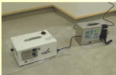
オゾンガス発生器(BT-02)とオゾンガスセンサー(BT-08 II)が連動して除菌の進捗を確認することができます。
